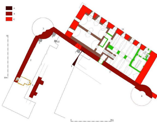
Obr. 16. Plán známé části hradního areálu v úrovni sutěru. A – konec 13. stol.; B – počátek 14. stol.; C – 2. polovina 14. stol. 1 – nejstarší hradní stavba, 2 – mladší obvodové opevnění, 3 – severozápadní věž, 4 – severovýchodní věž, 5 – brána, 6 – relikt západní budovy, 7 – jímka 10036, 8 – jímka 4013, 9 – jímka 13037, 10 – jímka 14017, 11 – hradní palác (kresba M. Sýkora).
